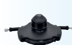
CONDENSADOR DE CONTRASTE DE FASE (DIAL)
