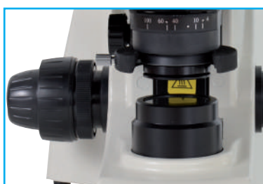
COLECTOR Y CONDENSOR
